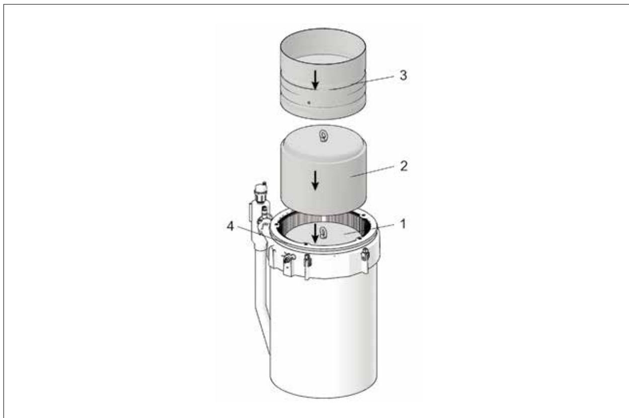
**Fig. 6.9 Ensamblar la cámara de combustión**
