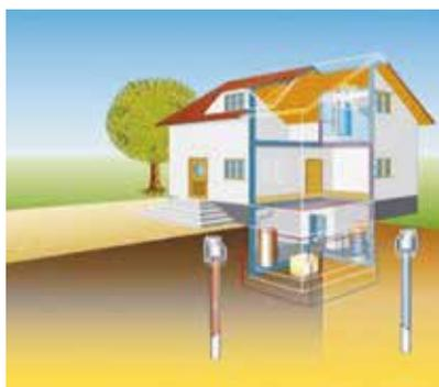
Esquema de la instalación - Pozo impelente de agua y pozo sumidero
