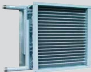
Como calentadores se utilizan baterías de calor de grandes dimensiones. Esto tiene la ventaja de poder alcanzar temperaturas de salida de aproximadamente 36 °C también en calefacciones de baja temperatura o poder calorífico con diferencias de temperatura de impulsión/retorno de 50/40 °C y caudal máximo en modo de recirculación.
