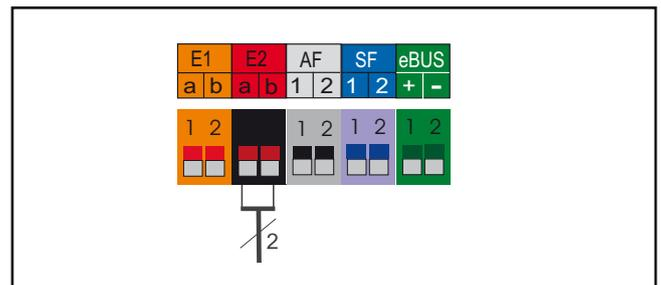
Fig.: Connecting input E2
