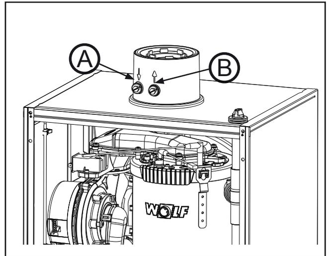
Fig.: Testing the flue gas parameters
